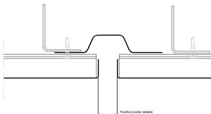
B-B': PANEL DE FACHADA JUNTA HUELLO 20MM
