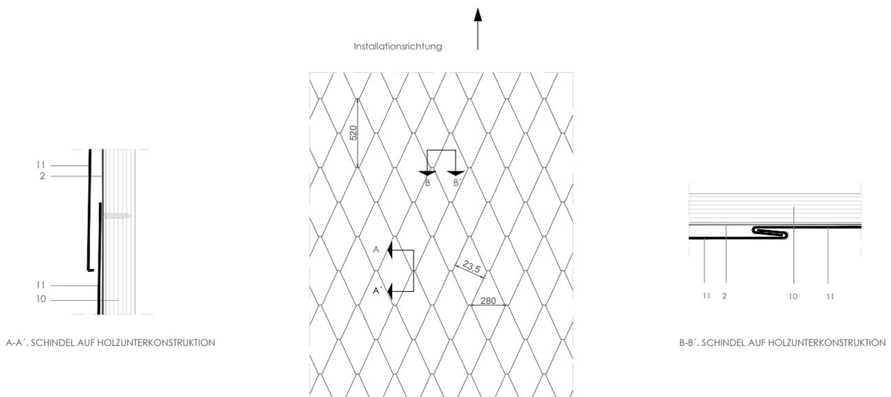
A-A', SCHINDEL AUF HOLZUNTERKONSTRUKTION
