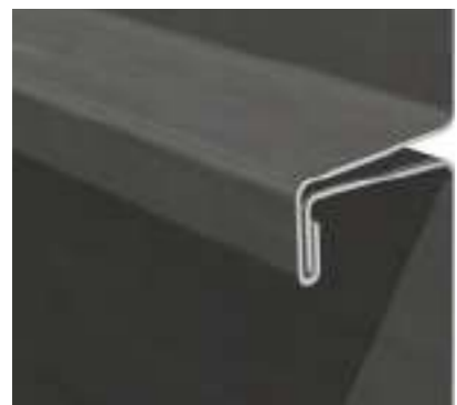
Junta alzada en ángulo colocado en vertical y horizontal
