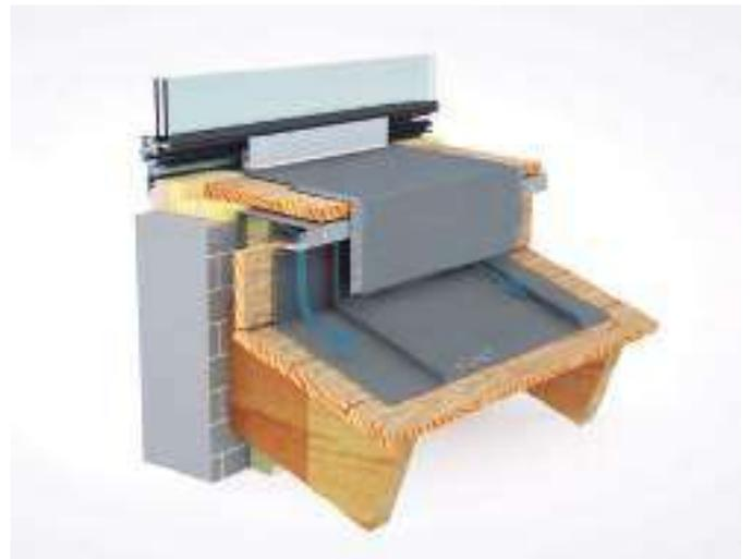
DLSS 6.1.01 – Remate a muro ventilado debajo de ventana.
