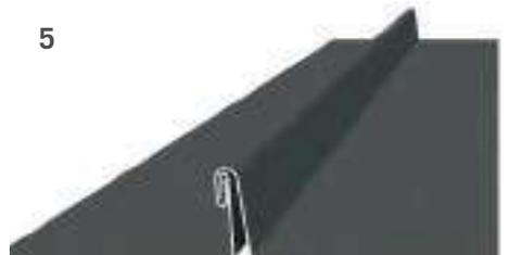
Junta alzada de doble engatillado
