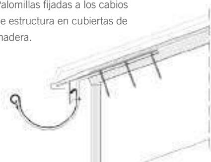
Tablero grueso permite la fijación de las palomillas independientemente de la estructura de la cubierta
