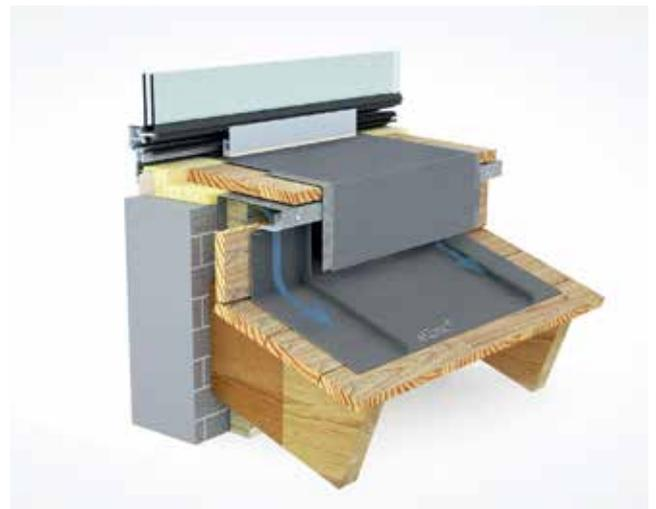
DLSS 6.1.01 – Remate a muro ventilado debajo de ventana.
