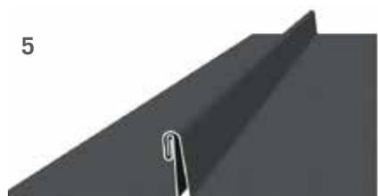
Junta alzada de doble engatillado.
