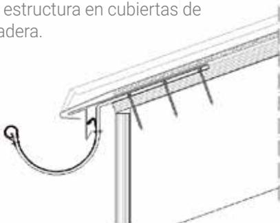
Tablero grueso permite la fijación de las palomillas independientemente de la estructura de la cubierta.
