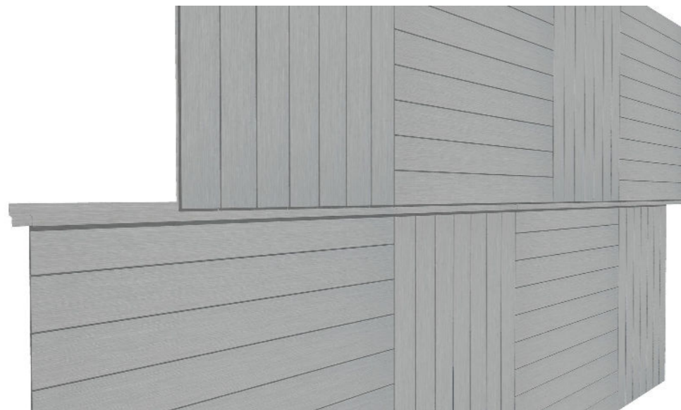
Détail de bardage avec combinaison horizontale et verticale.
