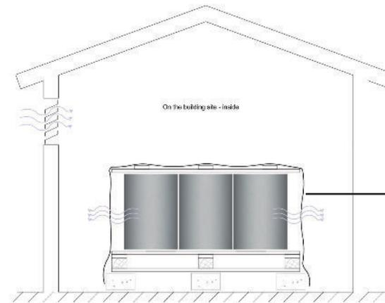
Atmungsaktive Abdeckungen schützen das Material vor Staub und verhindern Feuchtigkeitsbildung. Zwischen dem Zink und der Abdeckung muss ein Zwischenraum gelassen werden.
